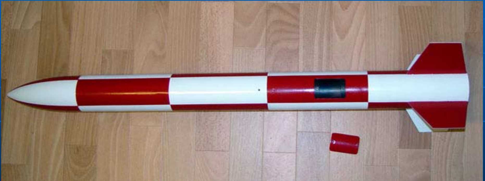
Die M.A.D.3 – Außenhülle noch ohne Einbauten
